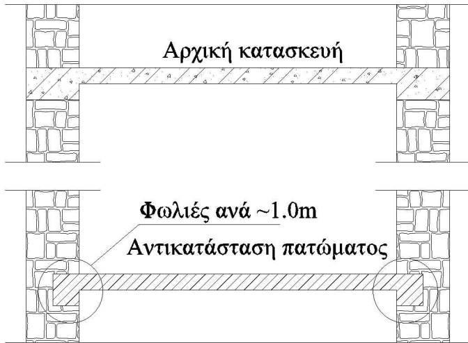
α. Πλάκες οπλισμένου σκυροδεμάτος
