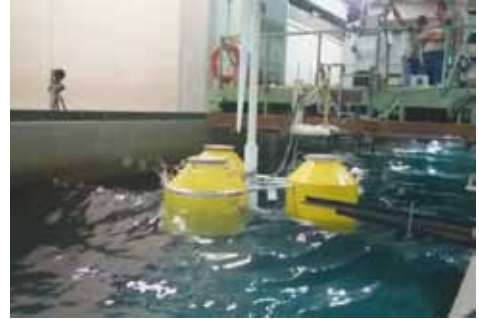
Εικόνα 20: Υπό κλίμακα πειράματα της πλατφόρμας REFOS στην πειραματική δεξαμενή του Εργαστηρίου Ναυτικής και Θαλάσσιας Υδροδυναμικής της Σχολής Ναυπηγών Μηχανολόγων Μηχανικών του Ε.Μ.Π.
