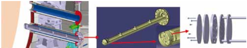
Σχήμα 5. Σχηματική απεικόνιση των δειγματοφορέων όπου τοποθετήθηκαν οι ανιχνευτές VERDI (από αριστερά: σωλήνας δειγματοφορέων στο tokamak, δειγματοφορείς εντός του σωλήνα, διάταξη δειγματοφορέων).
