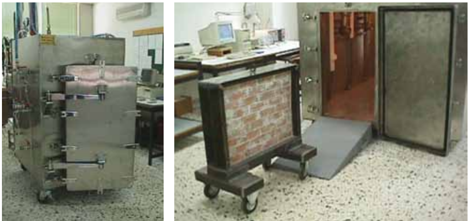
Σχήμα 6. Οι δύο θάλαμοι ραδονίου του ΕΠΤ-ΕΜΠ (αριστερά 1.8\text{m}^3 και δεξιά 8.5\text{m}^3 ).
