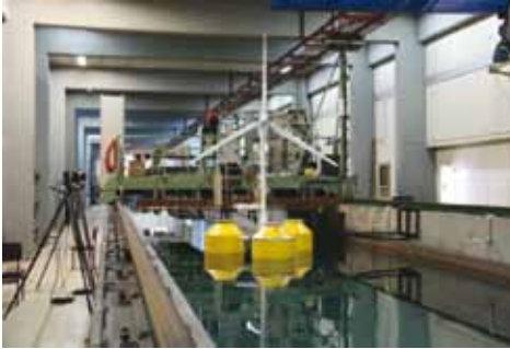
Εικόνα 20: Υπό κλίμακα πειράματα της πλατφόρμας REFOS στην πειραματική δεξαμενή του Εργαστηρίου Ναυτικής και Θαλάσσιας Υδροδυναμικής της Σχολής Ναυπηγών Μηχανολόγων Μηχανικών του Ε.Μ.Π.
