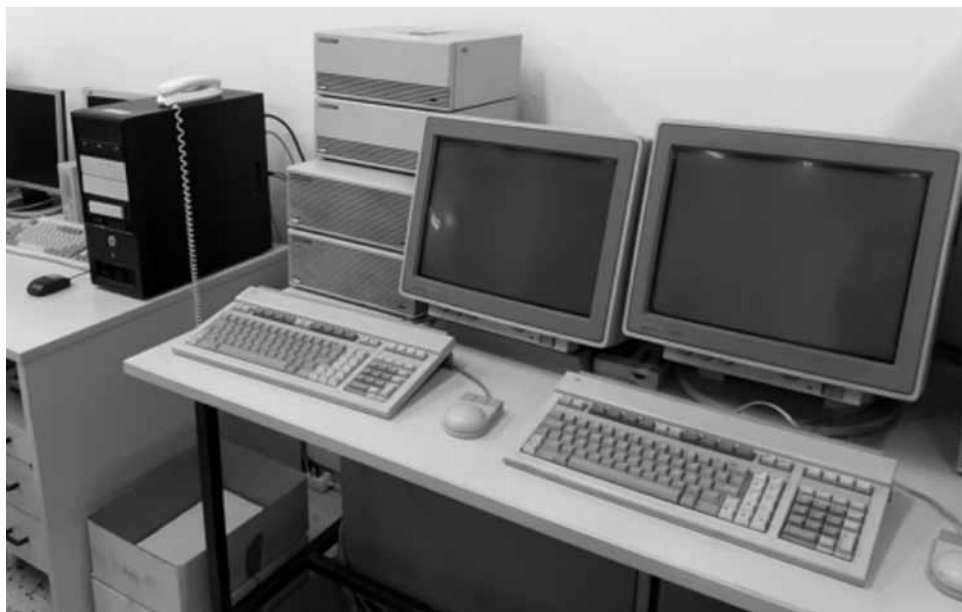
Εικόνα 16. Ο supermini υπολογιστής τύπου HP-9000/320 με λειτουργικό σύστημα HP-UX 7.03, όπως βρίσκεται στο ΕΠΤ-ΕΜΠ σήμερα (2022). Έτος αγοράς 1987.
