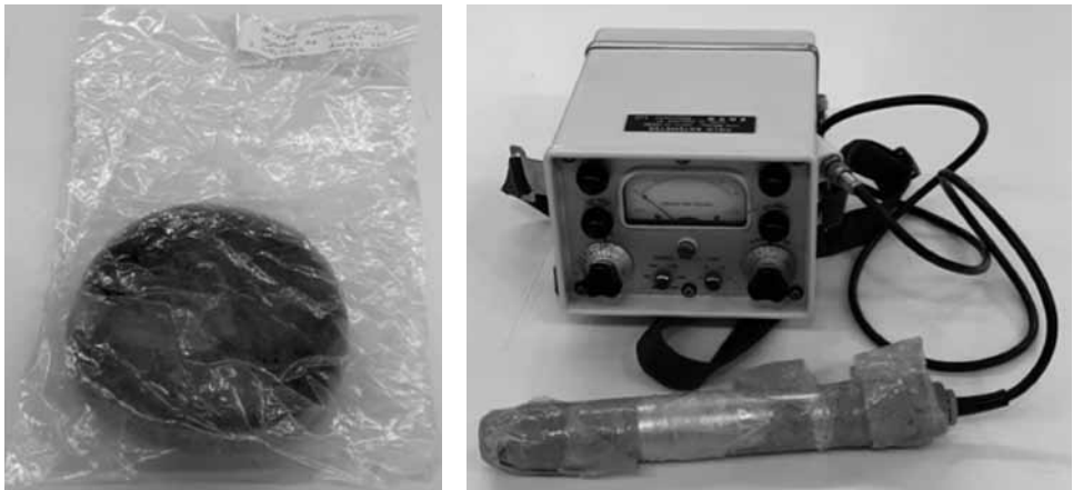
Εικόνα 10. (α) Αριστερά: Φίλτρο στο οποίο βρέθηκε Am-241 τον Μάιο του 1986 (β) Δεξιά: Παλιός φορητός ανιχνευτής Ιωδιούχου Νατρίου, οίκου ΕΣΚΟ που χρησιμοποιήθηκε για τον εντοπισμό περιοχών με αυξημένη εναπόθεση Cs-137
