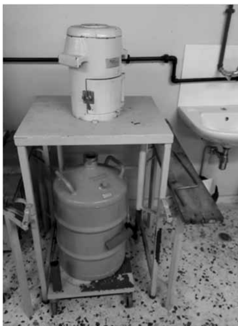
Εικόνα 7. (α) Αριστερά: Η θωράκιση του ανιχνευτή της Εικόνας 5. (β) Δεξιά: Ο ανιχνευτής τύπου Υπερκαθαρού Γερμανίου του οίκου CANBERRA - ΗΠΑ, όπως λειτουργεί σήμερα (2022)
