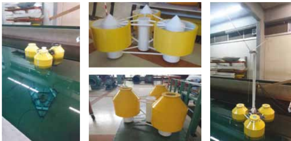
Εικόνα 19: Το υπό κλίμακα 1:60 πρότυπο της πλατφόρμας 1/60: (α) αριστερά η βάση συγκράτησης του TLP συστήματος αγκύρωσης, (β) κέντρο άνω: ανωστικοί κύλινδροι της πλατφόρμας και τοιχώματα των συσκευών ταλαντευόμενης υδάτινης στήλης, (γ) δεξιά: το πρότυπο στην πειραματική δεξαμενή, (δ) κέντρο κάτω: θάλαμοι συσκευών ταλαντευόμενης υδάτινης στήλης με τα κωνικά τους σκέπαστρα εκτός της πειραματικής δεξαμενής.
