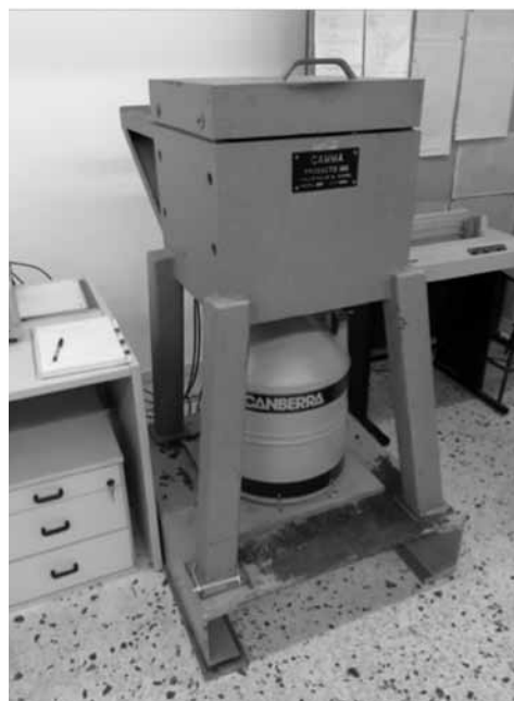
Εικόνα 7. (α) Αριστερά: Η θωράκιση του ανιχνευτή της Εικόνας 5. (β) Δεξιά: Ο ανιχνευτής τύπου Υπερκαθαρού Γερμανίου του οίκου CANBERRA - ΗΠΑ, όπως λειτουργεί σήμερα (2022)
